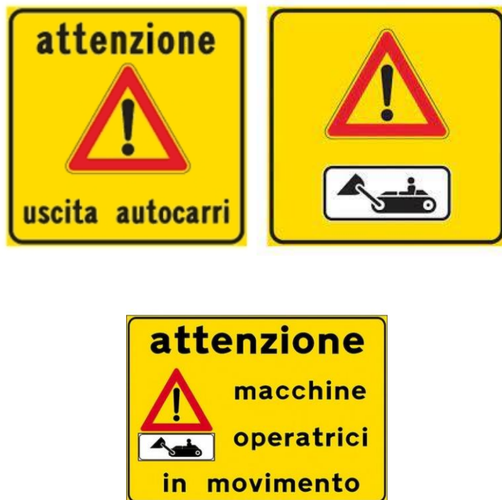
Figura 2 – Segnaletica di cantiere per segnalare la presenza di mezzi d'opera e autocarri interferenti con viabilità ordinaria
